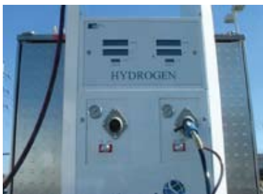
Un distributore per il rifornimento di idrogeno
